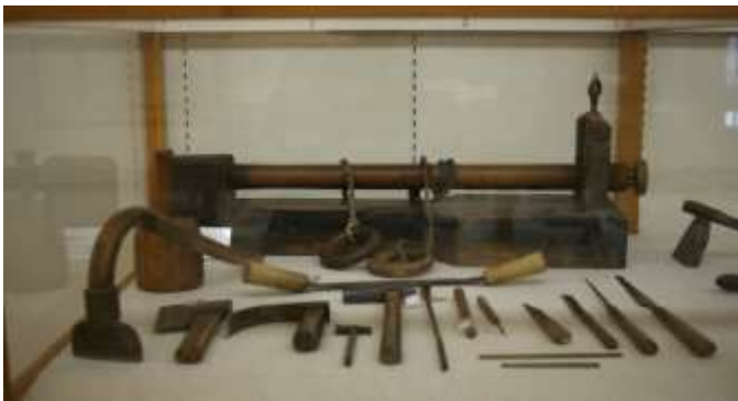
図 1： 木地師道具の一部（奥の台が轆轆、右手前の刃物が轆轆鉋）
